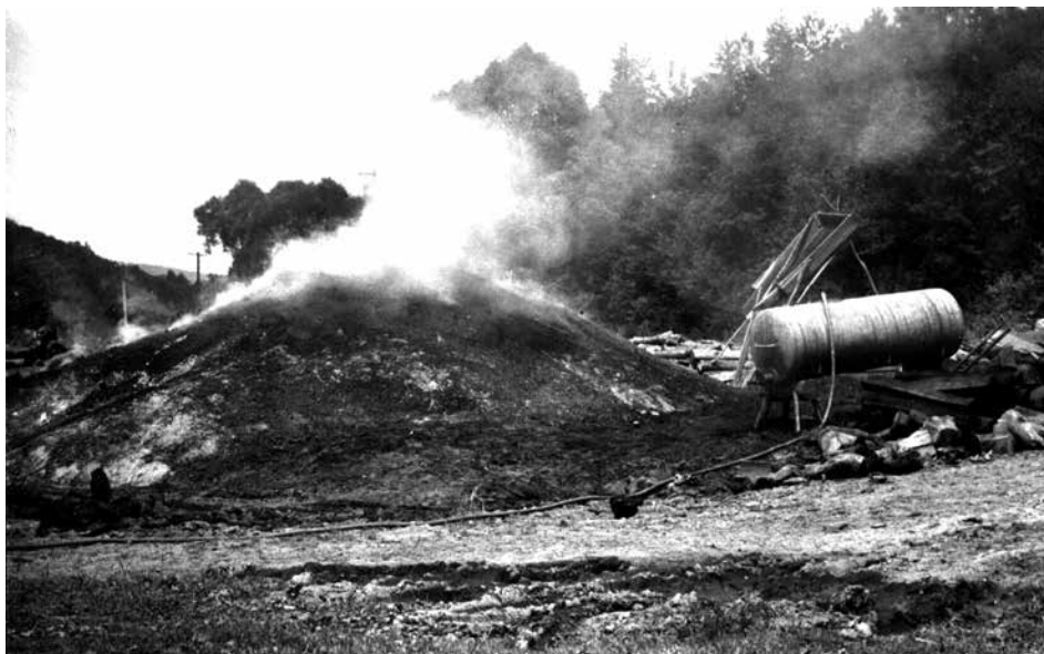
Ryc. 3. Wygaszony, stygnący mielerz (Fot. E. Miśkowiec). Fig. 3. Cooling earth-mound kiln (Phot. E. Miśkowiec).
