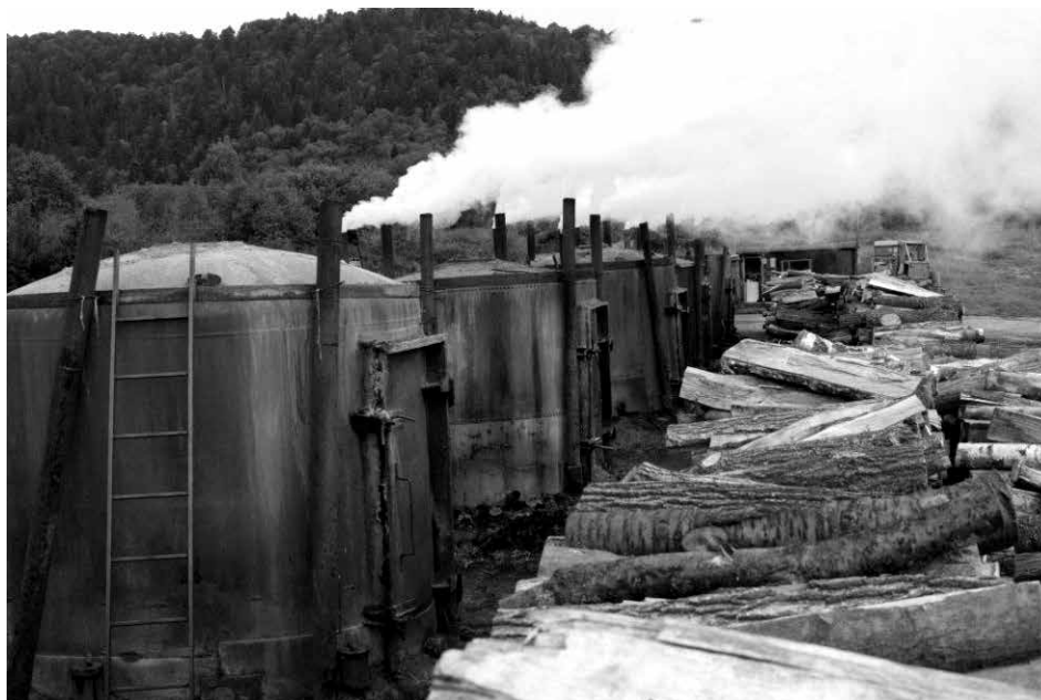
Ryc. 5. Wypał węgla drzewnego w retortach (Fot. E. Marszałek).
